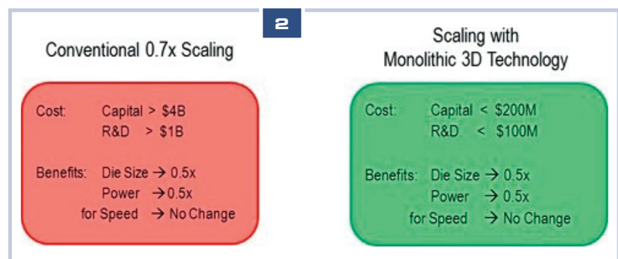
Bild 2. Herkömmliches und MonolithC-3D-Skalieren für Logikcores: Kosten und Vorteile im Vergleich
